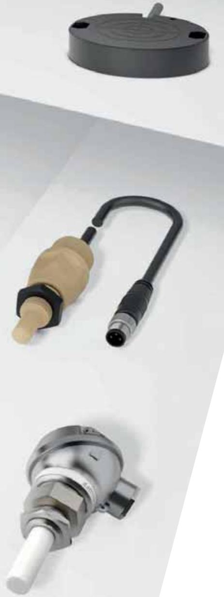
巴鲁夫电容式传感器能够以直接接触的方式或者穿透非金属容器壁检测液体、颗粒和粉末。它们是粘贴型传感器，能够灵活贴合外壳形状，拆卸方便。即使透过厚度达 10 mm 的玻璃和塑料壁，也能够补偿任何类型的湿气、泡沫和沉积物。这使得这些传感器非常适合用作导电介质的料位检测传感器，同时还确保较高的应用安全性。
