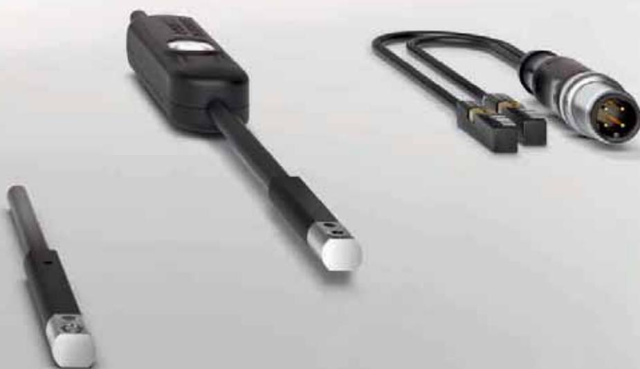
我们的磁场传感器主要用在气缸和机械抓手上，负责监测活塞位置。传感器能够穿透执行器壁，识别集成在活塞中的磁体的磁场，即便活塞处于高速运动中，传感器工作也不受影响。
