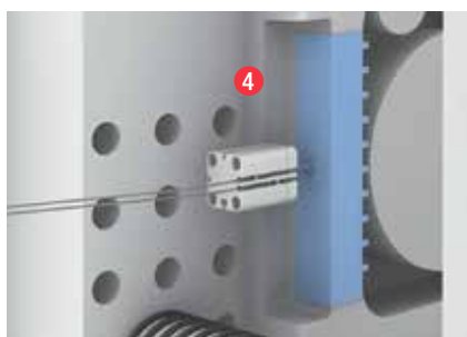
检测抽芯机构的位置
